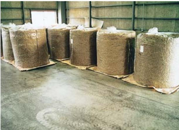
写真5 圧縮、梱包された1個900kgの製品。製品には製造情報が記入されたシールがはられる。
