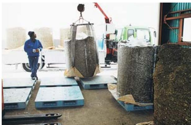
写真17 運搬補助資材「座トン」を使ったTMRの荷降ろし作業。
