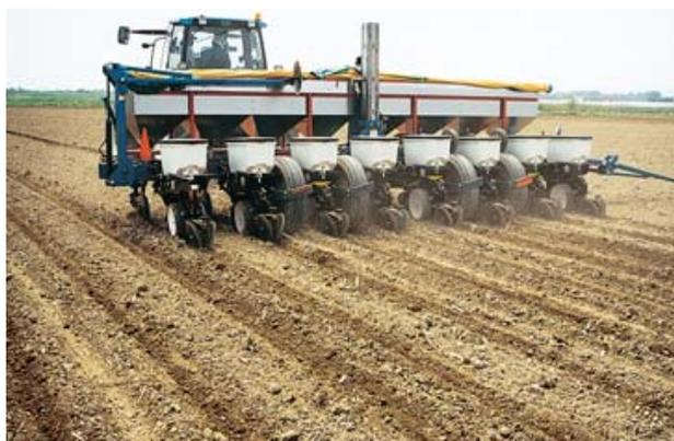
写真15 不耕起プランターによるは種作業。
