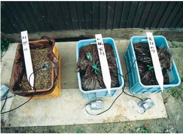
写真1 農場段階での変敗防止のためのTMR保存試験
