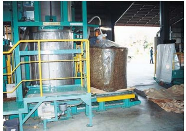
写真4 完成したTMR圧縮、梱包システム。ビニール袋でパッキングし、抜気を行う。
