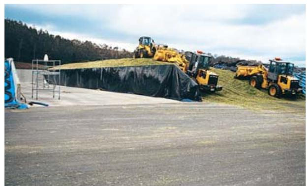
写真10 詰め込み終盤の踏圧、整形は3台のショベルローダーを使用する。
