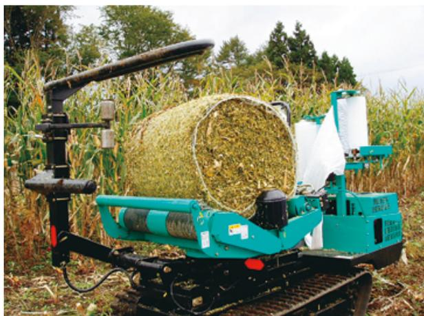
写真6 成型された細断とうもろしをラッピング中
