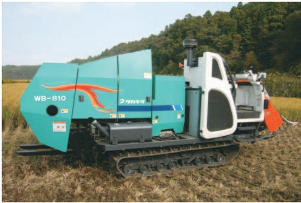
写真1 自走細断型ホールクロープ収穫機（中央農研）
