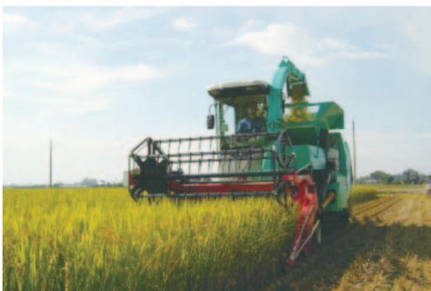
写真2 自走式細断型ロールベアラ（生研センター）
