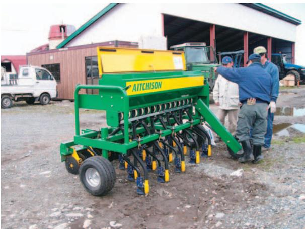
択できます。個人農家には3点リンク式で作業幅が2.1mのエコノミータイプ（シードマチック・グラスファーマー）が多く使われています。
