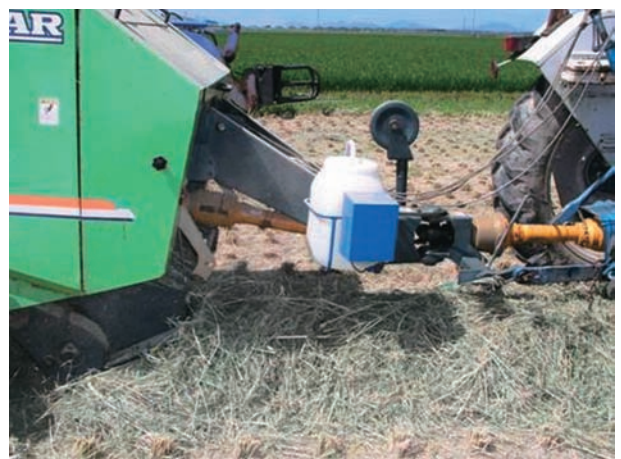
写真6 添加機搭載事例（ロールベラー）
