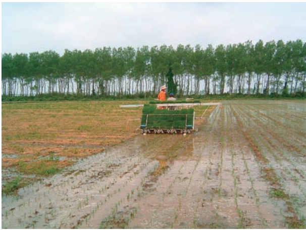
写真7 細断被覆後の不耕起移植作業
