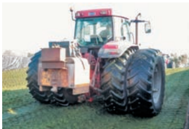
写真3 ダブルタイヤで重り付きの踏圧専門トラクター
