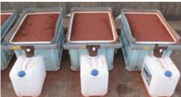
写真2 土壌流亡量を調査したコンテナ枠
