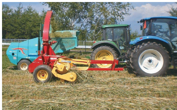
写真4 スーダン型ソルガムのフォーレイハーベスタ・細断型ロールベール体系による収穫（モアコンディショナで刈れば、茎の水分が早期に低下するので、反転・集草作業の必要はなく、土砂の混入もない）
