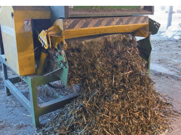
写真3 ベールカッタによるスーダン型ソルガムロールベールサイレージの細断
