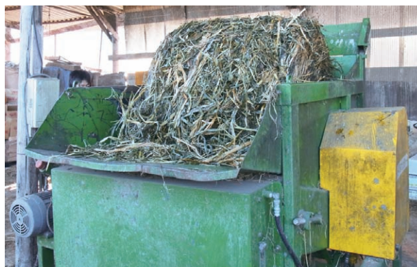
写真4 スーダン型ソルガムのフォーレイハーベスタ・細断型ロールベール体系による収穫（モアコンディショナで刈れば、茎の水分が早期に低下するので、反転・集草作業の必要はなく、土砂の混入もない）
