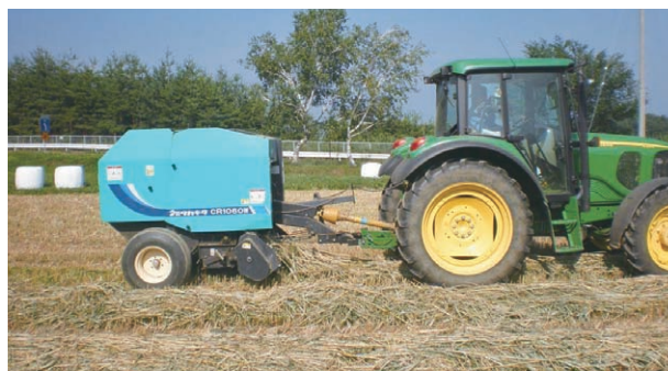
写真2 スーダン型ソルガムのロールベールによる収穫（モーアコンディショナで刈れば、茎の水分が早期に低下するので、反転・集草作業の必要はなく、土砂の混入もない。収穫はカッティングモードで行う。）
