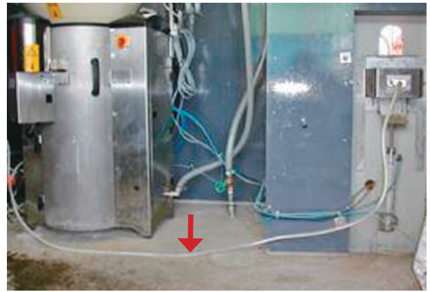
写真2 哺乳ロボット授乳ホースの悪い配置の一例 ホースが長すぎ、床に接している (矢印)。
