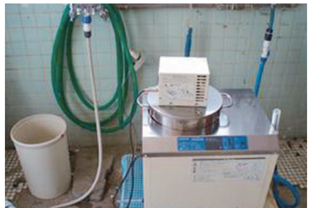
写真1 初乳・生乳加温殺菌装置(パステライザー 北海道オリオン社製)
