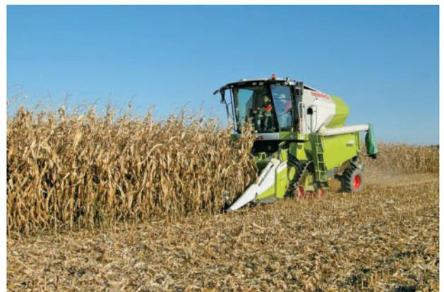
写真3 コーンヘッドによる子実収穫
