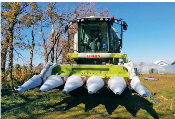
写真2 コーンヘッド（CLAAS製コンスピード）装着コンバイン
