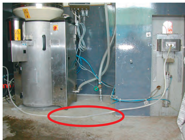
写真1. 哺乳ロボット授乳ホースの誤った設置 (丸で囲んだ部分が床に接している)
