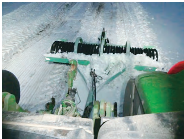
写真3 積雪が深く雪を抱いて引きずるケンブリッジローラー
