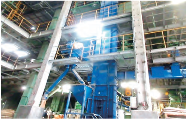
抗菌剤専用ライン：機械色は青 ※抗菌剤無添加ライン機械色は緑
