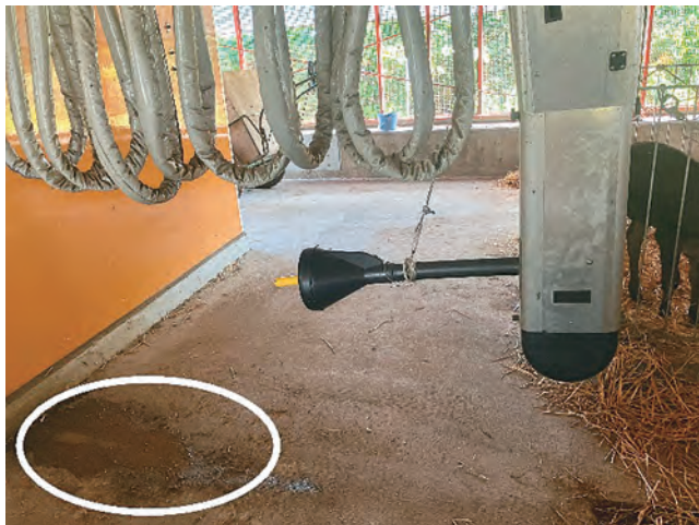
写真2 パーキング位置での排水イメージ（○部分のように床に排水が溜まる場合がある）
