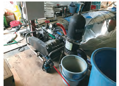
写真2 B農園の灌水システム (溶液は水に希釈しないでバケツに入れ流し込む仕組み)
