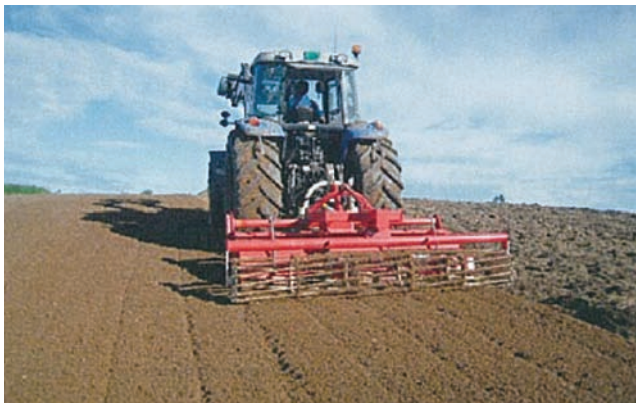
写真2 アッパーロータリーによる碎土整地
