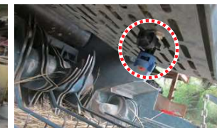
噴霧ノズルの設置例(ロールベアラー)
