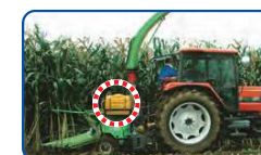
2条刈りコンハーベスターへの搭載例(100Lタンク)
